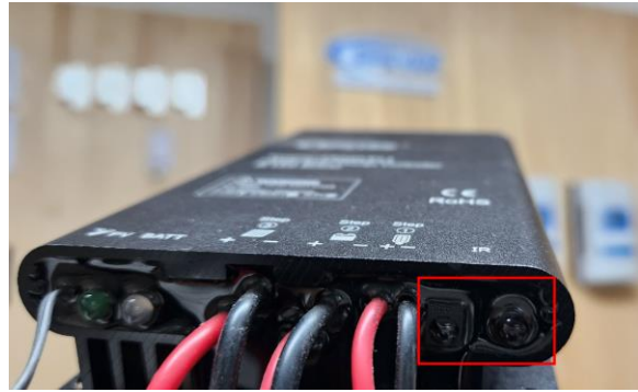
컨트롤러 적외선 송수신기
